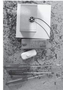
eine Nachttischlampe aus einem Schalter, einem Transformator, einem Holzplättchen, einer LED-Lampe, einem Hasengitter und einem Stück Tischtuchpapier.
